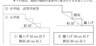
階段の傾斜をちょうど33°とするとき, 蹴上げを18cm以下にするために は、踏面をどのような範囲に設定すればよいか。踏面をx cm として、x oとり得る値の範囲を求めるための不等式を,33°の三角比とxを用いて表 せ。解答は、解答欄 (い) に記述せよ。ただし、踏面と蹴上げの長さはそ れぞれ一定であるとし、また、踏面は水平であり、蹴上げは踏面に対して垂 直であるとする。
